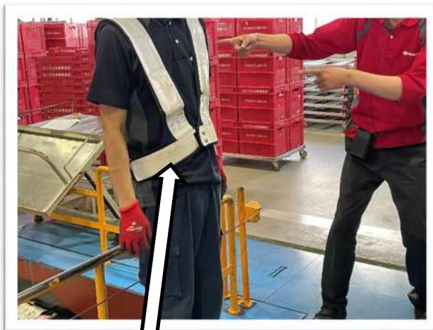
万が一、大型圧縮機のベルトコンベアに人が落ちても、この「センサー付きベスト」を装着しているため、自動的に大型圧縮機は緊急停止するそうです。その他に腰痛対策サポーター装着し、安全靴を履いていました。職員の健康・命を大事に考えた安全対策でした！
